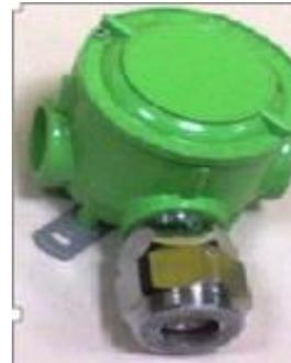
➔ La **taratura ricorrente** assicura il corretto funzionamento del dispositivo garantendo nell'arco di vita dell'elemento sensibile la segnalazione di allerta alla soglia di pre-allarme e l'attivazione automatica della ventilazione di emergenza alla soglia di allarme del 18%O<sub>2</sub>.
