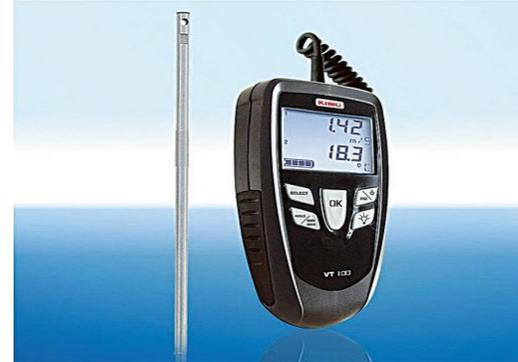
Nella misura del numero dei ricambi/ora è molto importante tenere presente che la sonda (anemometro a ventolina o filo caldo) rileva **la velocità dell'aria in un punto di misura alla volta e anche creando delle medie su più punti non avremo mai una precisione assoluta nella misurazione.**
