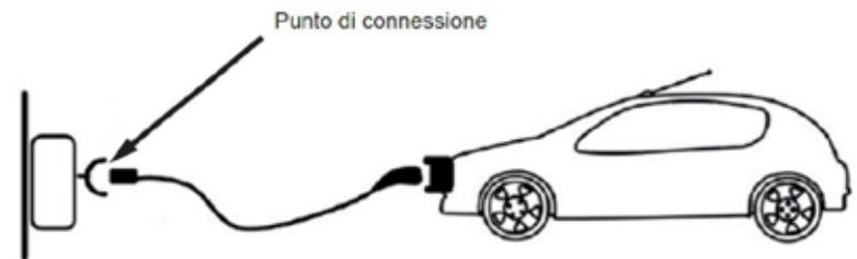
Punto di connessione costituito da una presa fissa che è parte di un EVSE installato in modo fisso
