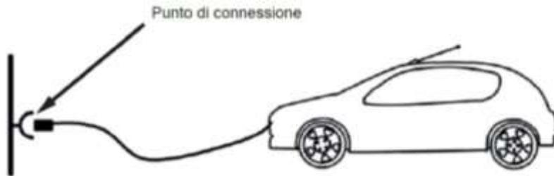
Punto di connessione costituito da una presa fissa che non è parte di un EVSE installato in modo fisso
