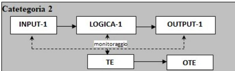
Cat. 2 basata sull'applicazione di un canale di Test che **verifica la funzione** a intervalli regolari –  $PL_{max}$ : «d»
