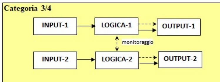
Cat 3/4 basate sull'applicazione di una copertura **diagnostica DC** (freccia tratteggiata in figura a lato) che in Cat. 4 raggiunge livelli superiori (99%) a quelli in Cat. 3 –  $PL_{max}$  : «e»
