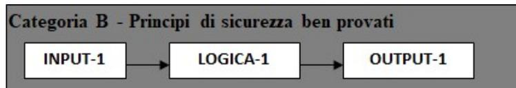
Cat. B basata sull'applicazione di **principi di sicurezza di base** –  $PL_{max}$ : «b»
