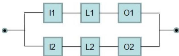
**Canale ridondante:** è caratterizzato dalla struttura, cioè ridondanza e diversità e possibilità di monitoraggio dei guasti. Il singolo guasto non porta alla perdita della funzione di sicurezza
