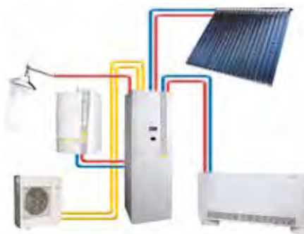
Schema idraulico di principio della centrale di calore LibraVario Aqua
